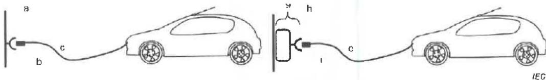
3. Caso C: Conexión del vehículo eléctrico (f) a la red de alimentación (a, g y h) con cable (c) extraíble (e) equipado con conector (d) y toma de corriente (i y b) móvil.
